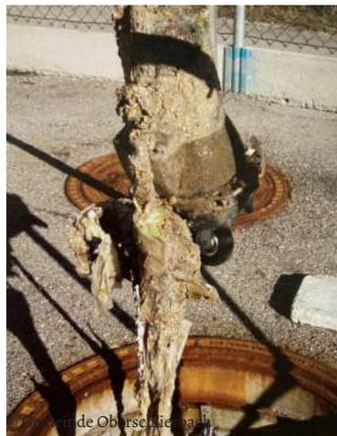
Werden Abfälle mit Kunststofffasern entsorgt, so führt das zu Verstopfungen der Abwasserpumpen. Außerdem verharzen Kunststoffe und zerstören dadurch Dichtungen. Beim Ausfall eines Pumpwerks kommt es unweigerlich zum Abwasserstau. Die Auswirkungen können sich im schlimmsten Fall auch im eigenen Haus bemerkbar machen.
